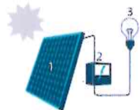
1 Zonnepaneel (2) Omvormer (3) Verbruiker (lampje)
